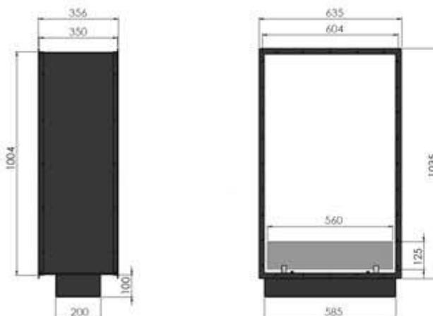
Tipologia - da montare in una nicchia, le cornici del caminetto possono sovrapporsi all'interno dell'apertura o essere a filo muro
