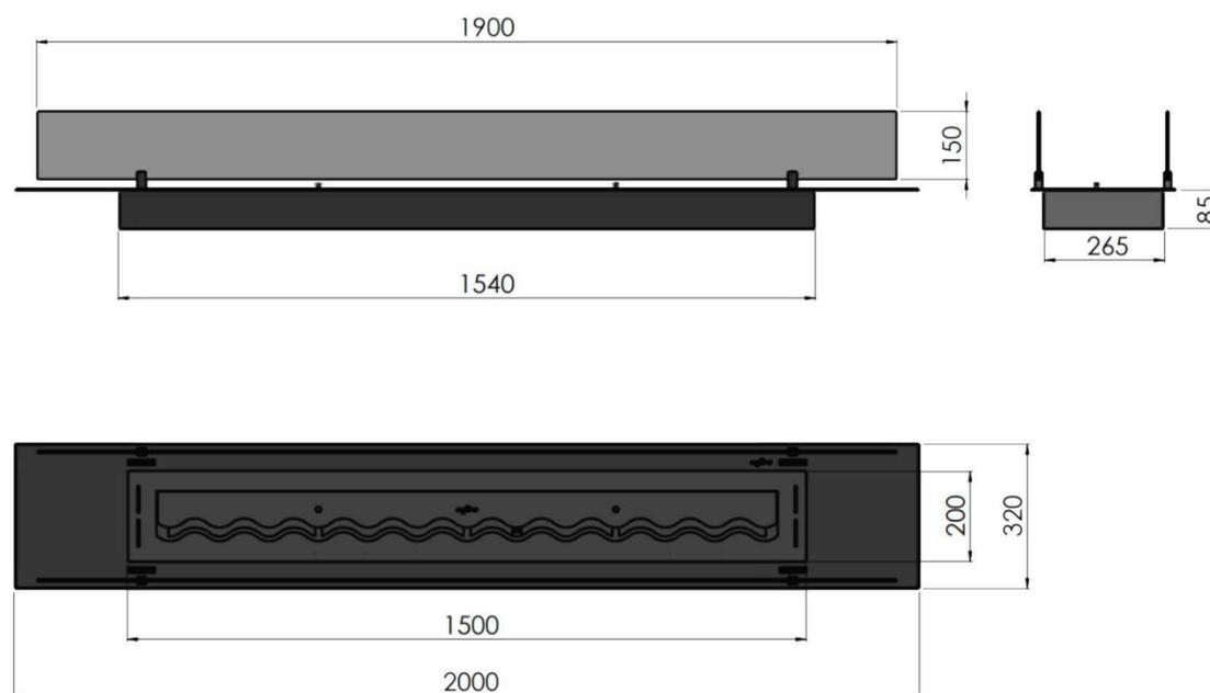
Tipologia - inserto biocamino da inserire in foro / nicchia, non necessita di coibentazione aggiuntiva
